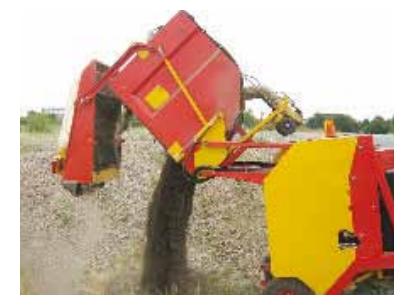
vaciado hidráulico (sobre 1,60 m de altura)
