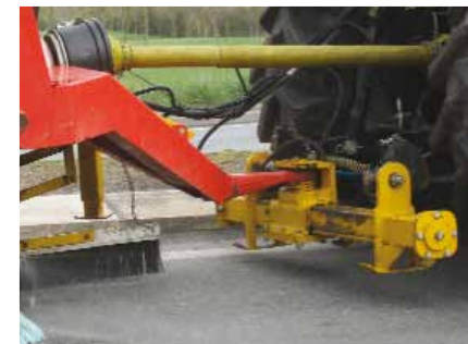
Enganche especial para desplazamiento lateral
